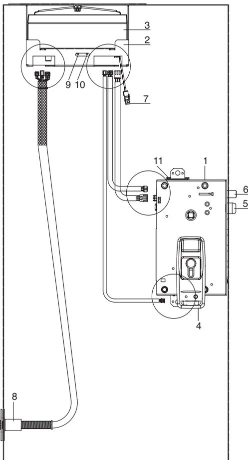
**⚠** **Importante:** massima pulizia durante l'installazione evitare che materiale ferroso (trucioli, polvere di ferro, ecc.) entri all'interno della serratura.
